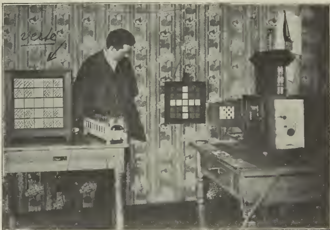
La visión á distancia.—Ernesto Ruhmer, inventor del procedimiento de la televisión, haciendo funcionar el aparato demostrativo por él construido. (De fotografía de World's Graphic Press.)
